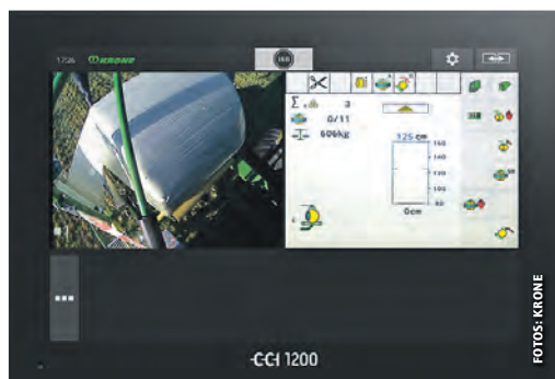
Durch die elektrische Pressdruckverstellung kann die Ballendichte vom Traktorsitz eingestellt werden.
