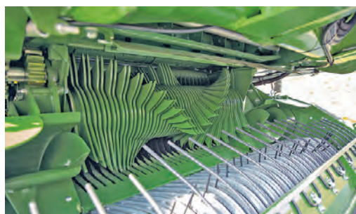
Rotor aus extra gehärteten Stahl (Hardox) mit 17 oder 26 Messern
