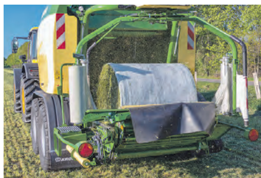
Wahlweise Mantelfolie- oder Netzbindung kann Krone als einziger Hersteller auch bei Variablen Presskammern anbieten.
